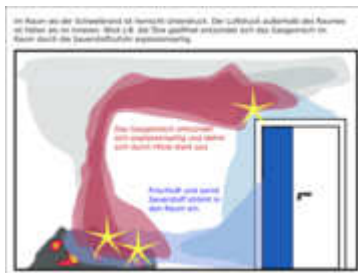
Skizze einer Rauchgasexplosion durch Öffnen der Tür
